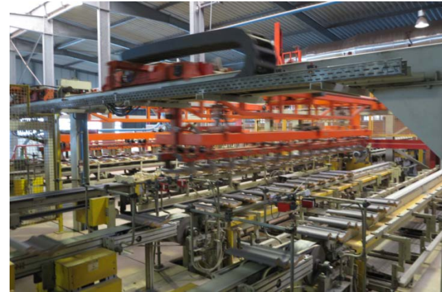
Einlegen der Rohlinge in H-Kassetten aus Cordierit
