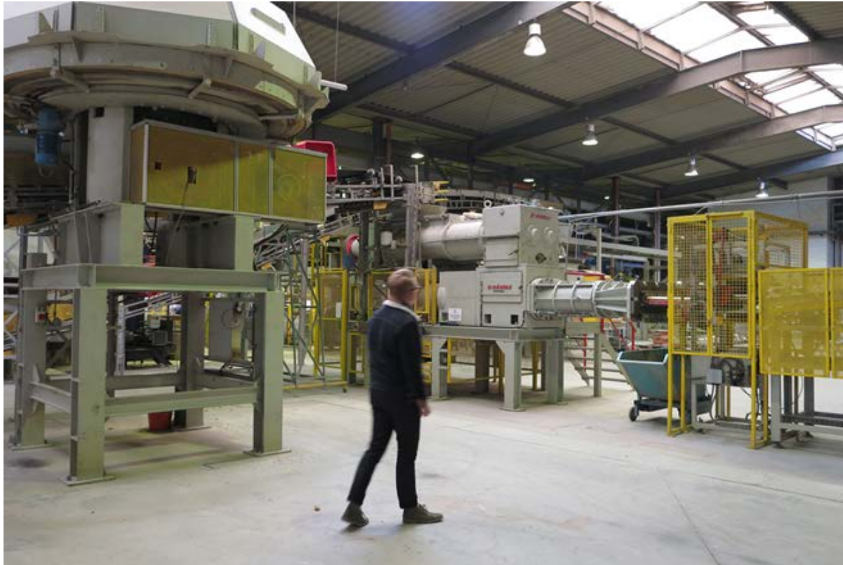
Siebrundbeschicker (Links) - Formgebung (Hinten-Mitte) - Batzen-Abschneider (Rechts) - Mensch (Vorne-Mitte)
