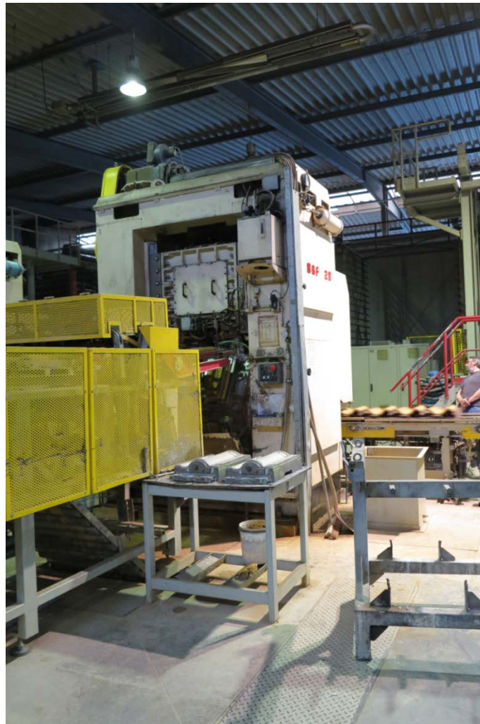
Revolverpresse für Dachziegel
